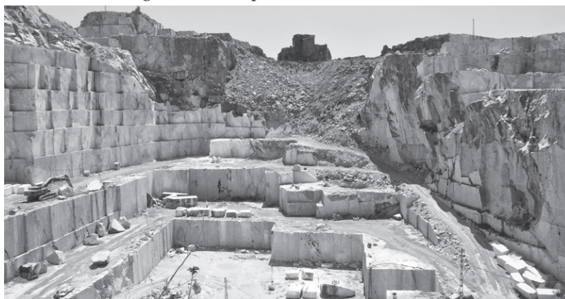
Fig. 1. Iscehisar, Afyonkarahisar. Panoramica del distretto estrattivo di Bacakale delle cave di Docimium (agosto 2011). A sinistra, il fronte nord-orientale con pareti verticali tagliate con il filo diamantato; a destra, il fronte sud-occidentale di epoca romana. La parte centrale ha sottoscavato il fondo della cava antica, il cui livello originario si può intuire ancora sulla parete destra.
